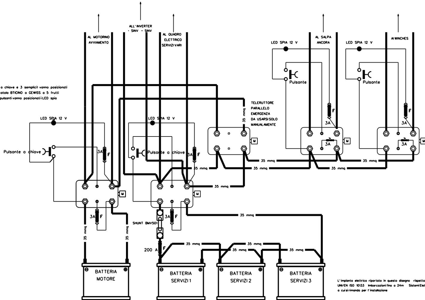
L'impianto elettrico riportato in questo disegno rispetta la normativa UNI/EN ISO 10133 Imbarcazioni fino a 24m Sistemi Elettrici Impianti a bassissima tensione in corrente continua a cui si rimanda per l'installazione
