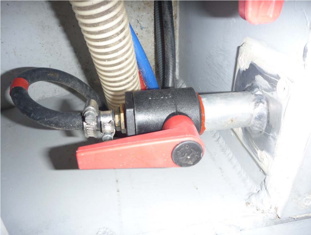
9-Ovni-Valvola uscita gasolio con guarnizione Viton, incollaggio pasta rossa
